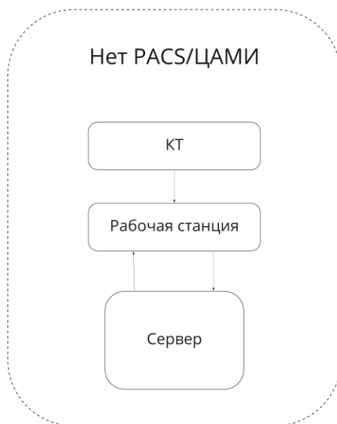
Рисунок №16. Схема развертывания ПО при отсутствии PACS/ЦАМИ - последовательная отправка данных
